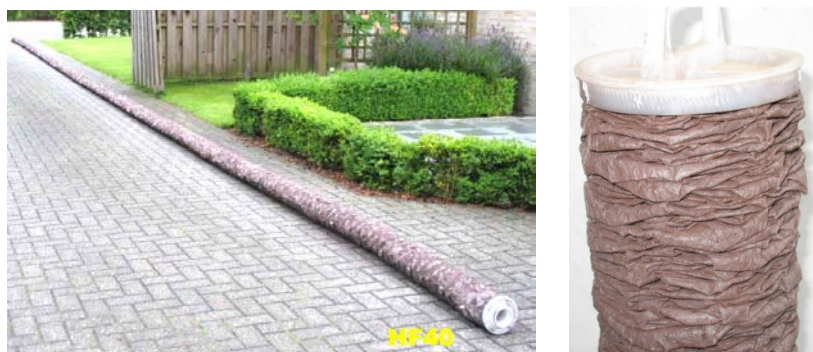
Рис. 4. Отработанный фильтропатрон 3М™ High Flow длиной 40 дюймов с перепиленным внутренним сердечником растянут по тротуару для демонстрации рабочей площади фильтрации (фото слева) и вид этого же патрона (15 микрон) после пропускания 21 400 кубометров пароконденсата (наружная сетка удалена).
