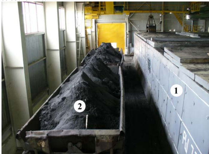
Рис.4. НСММЗ. Аппарат «ОКУД» оборотного цикл стана 250/150. Отгрузка обезвоженного осадка влажностью 15 \div 20\% .
