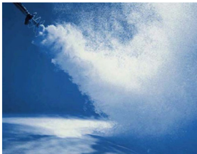
Рис.8 Мощное подводное перемешивание и мелкопузырчатая аэрация.
