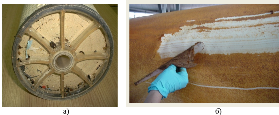
Рис.1. Загрязненные рулонные мембранные элементы: а) внешний вид; б) после вскрытия (аутопсии)
