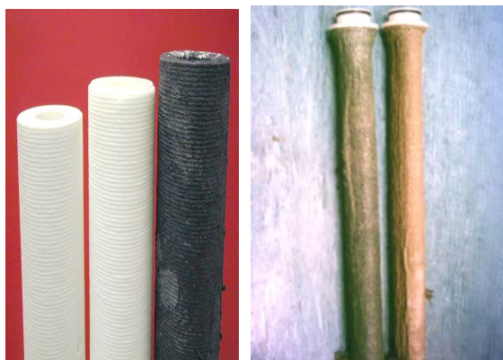
Рис. 1. Сравнение формы отработанных патронов с жесткой структурой фильтрующего материала (слева «жесткий» патрон – исходный вид и третий слева – использованный забитый патрон с неизменной формой), (справа вид отработанных забитых «мягких» патронов, изготовленных по технологии “melt-blown”, видно, что наружный диаметр патрона резко сократился, на теле патрона заметны складки и неровности смятого фильтрующего материала).
