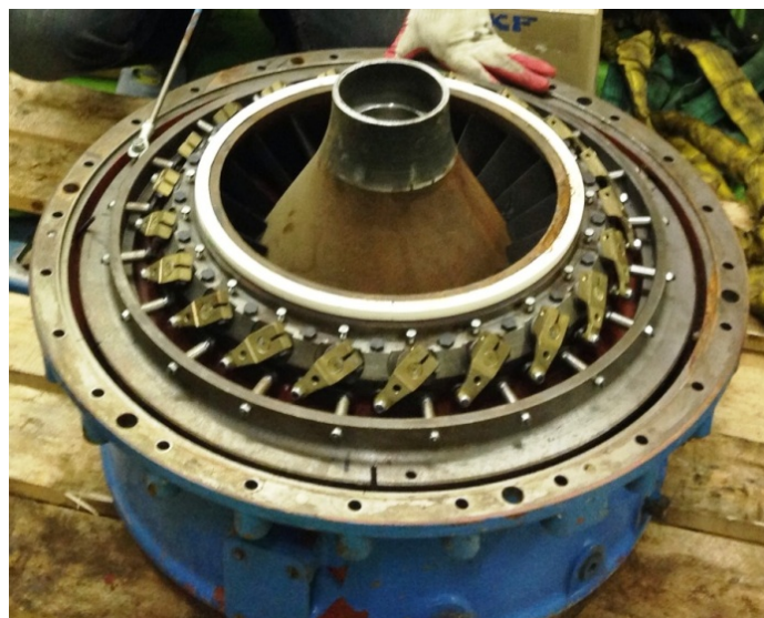
Рис. 11. Действующий блок управления поворотом лопаток воздуховулки, изготовленной в 1990 г., - на выставке «Экватэк 2014»
