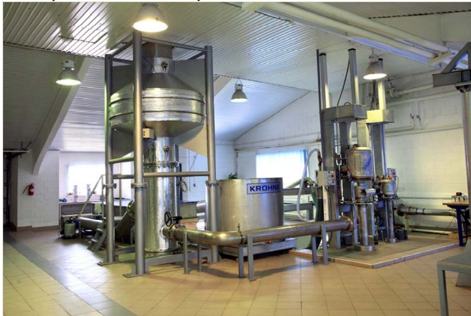
Рис.1 Калибровочная расходомерная установка на ООО КРОНЕ-АВТОМАТИКА для расходомеров с условным диаметром поверяемых расходомеров Ду 25 – 300 мм.
