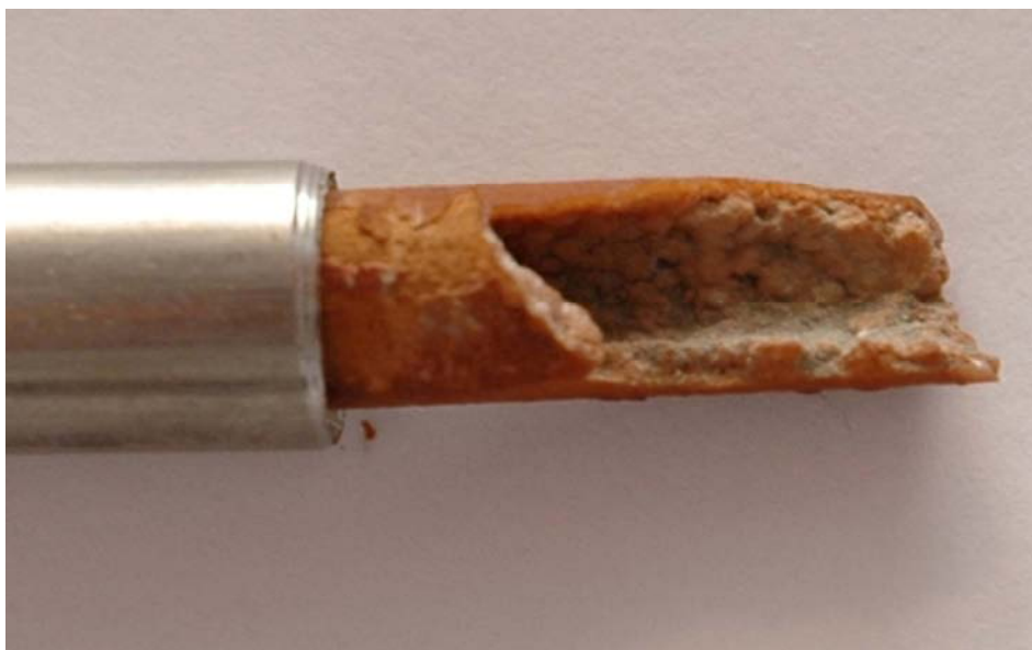
Рис.6. Отложение накипи в теплопередающих трубках компрессора за 6 месяцев работы
