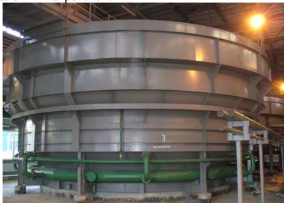
Рис. 2. Абинский ЭМЗ. Отстойник-флокулятор с технологическим диаметром 10 м. Производительность 450 \div 1500 \text{ м}^3/\text{час} .
