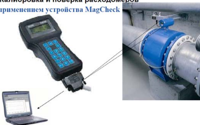
Рис.4 Диагностика, калибровка и поверка электромагнитного расходомера с применением устройства MagCheck
