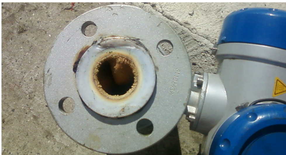
Рис2 Отложения и вспучивание футеровки у электромагнитного расходомера Optiflux
